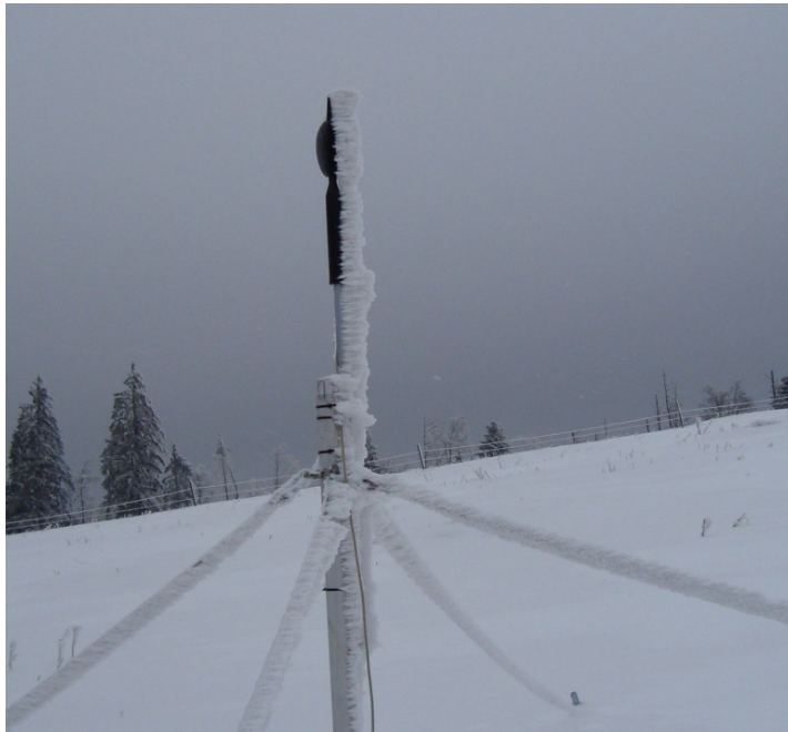
Abb. 49: Eisansatz an der Schallmessung in St. Brais.
