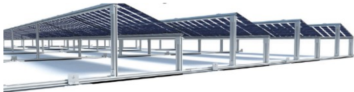
Abbildung 17: Bifaziales Montagesystem von Opsun Systems. Linienförmige Halterung für ungehinderte Diffusstrahlung auf die Modulrückseite.
