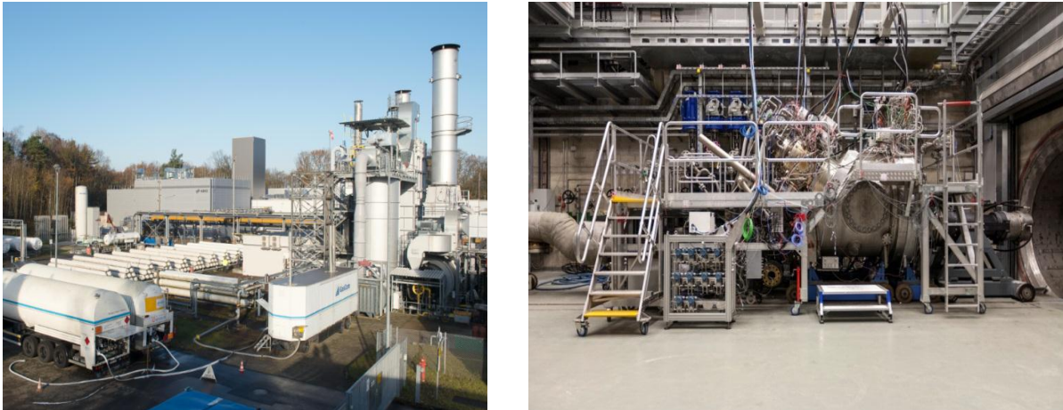
Abbildung 2: Ansicht der Testanlage sowie des GT36 Combustor Test Rigs im Betrieb
