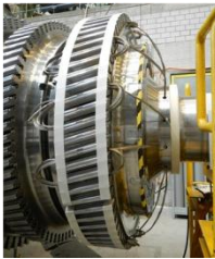
Abbildung 4: Beispiele von Prototypeninstrumentierung am Rotor
